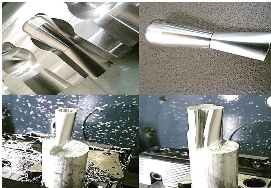
Рис. 3. Детали вкладыша пустот образателя форсунки для литейной формы, используемой в горнодобывающей промышленности
